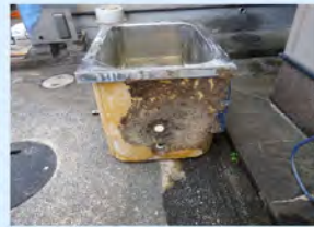
浴槽撤去品(白蟻巣あり)
